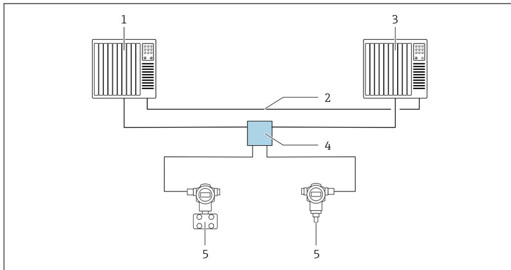
7 Пример компоновки резервируемой системы (S2): топология «звезда»
