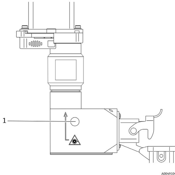
图 2. 激光联锁指示灯位置 (1)
