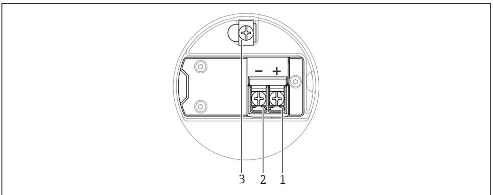
4 Bornes de raccordement et borne de terre dans le compartiment de raccordement
