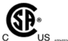
Рис 5. Ярлык, указывающий на допуск оборудования для использования во взрывоопасных зонах в США и в Канаде
