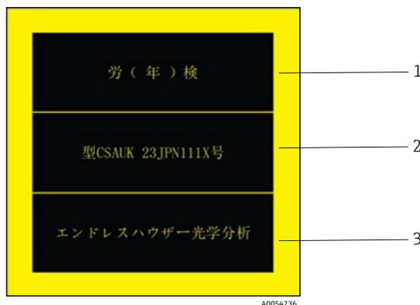
Рисунок 8. Ярлык JPEX для использования во взрывоопасных зонах
