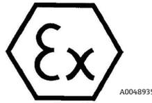
Рис 6. Маркировка АТЕХ для использования во взрывоопасных зонах
