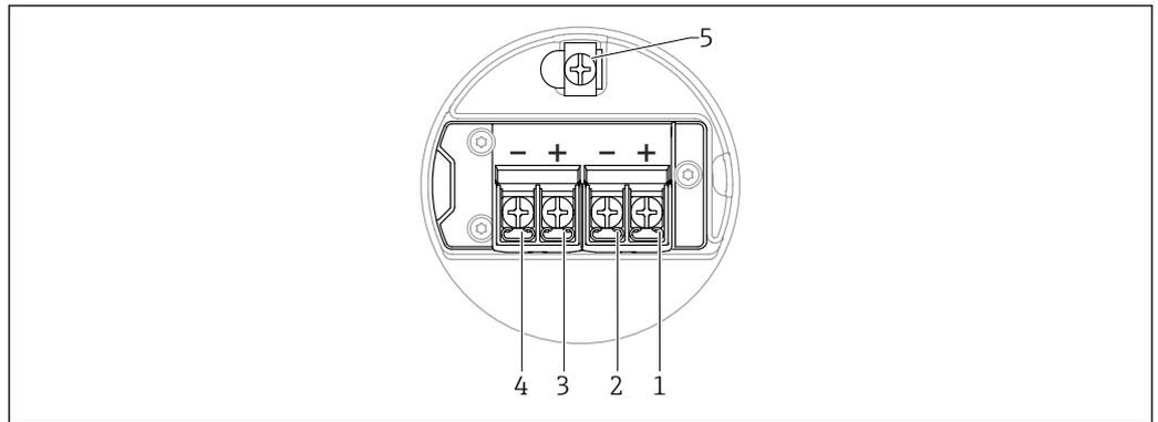
▣ 7 Affectation des bornes dans le compartiment de raccordement ; 4 ... 20 mA HART, sortie tout ou rien, boîtier à double compartiment
