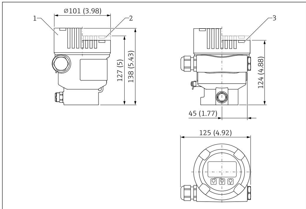
50 Dimensions ; boîtier à simple compartiment, aluminium, revêtu ; avec raccord M20 et bouchon, plastique.
