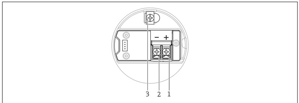
▣ 8 Affectation des bornes dans le compartiment de raccordement ; 4 ... 20 mA HART ; boîtier à double compartiment, forme L
