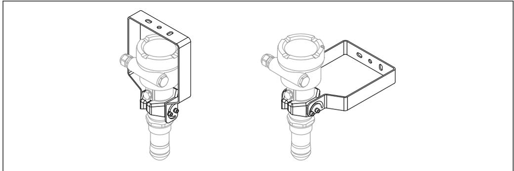
75 Étrier de montage réglable FMR6xB ; montage sur toit ou sur paroi
