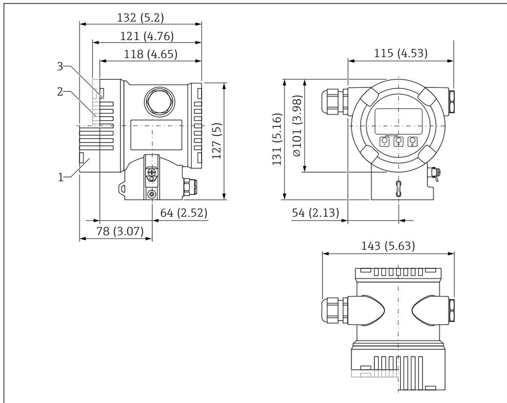
52 Dimensions ; boîtier à double compartiment, aluminium, revêtu ; avec raccord M20 et bouchon, plastique.
