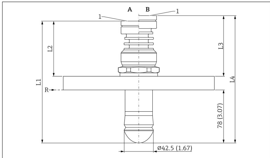
61 Dimensions de l'antenne drip-off 50 mm (2 in), bride UNI raccord process. Unité de mesure mm (in)
