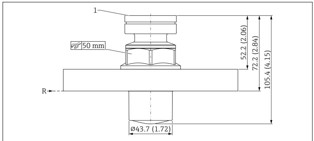
56 Dimensions de l'antenne encapsulée, PVDF, 40 mm (1,5 in), raccord process bride UNI. Unité de mesure mm (in)
