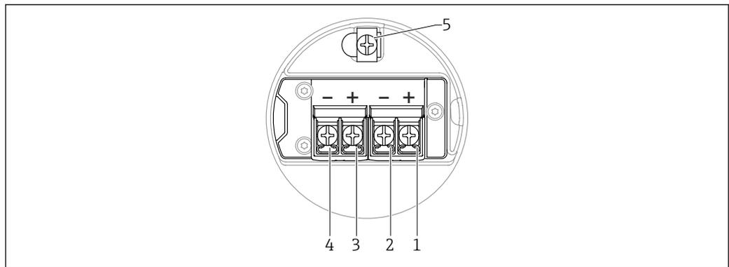
▣ 7 *Asignación de terminales en el compartimento de conexiones; 4 ... 20 mA HART, salida de conmutación, caja de compartimento doble*
