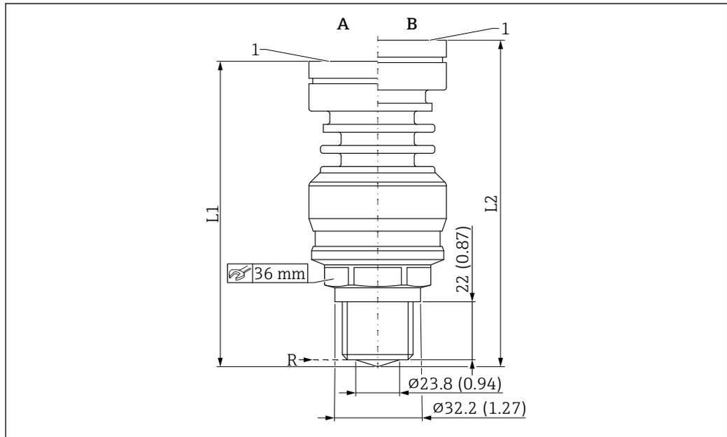
65 Medidas; antena integrada, PEEK, 20 mm (0,75 in); conexión a proceso, rosca de  $\frac{3}{4}$ ". Unidad de medida mm (in)
