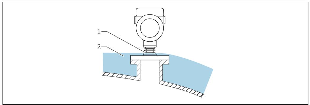
Si las temperaturas de proceso son altas, el equipo debería estar incluido en el sistema de aislamiento de containers (2) habitual para evitar que la electrónica se caliente debido a la radiación por dispersión térmica o la convección. La estructura de la nervadura (1) no debe estar aislada.
