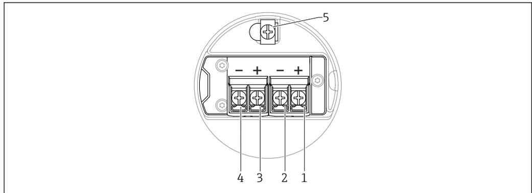
▣ 6 *Asignación de terminales en el compartimento de conexiones; 4 ... 20 mA HART + 4 ... 20 mA analógico; caja de compartimento doble*
