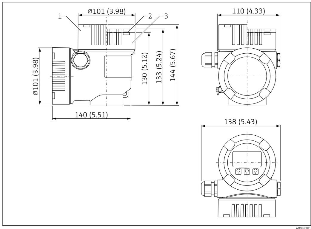
54 Medidas; caja de compartimento doble con forma de L, 316L; incl. acoplamiento M20 y tapón, plástico. Unidad de medida mm (in)
