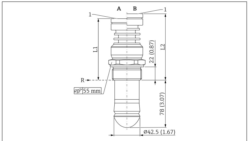
60 Medidas de la antena de goteo de 50 mm (2 in), conexión a proceso roscada
