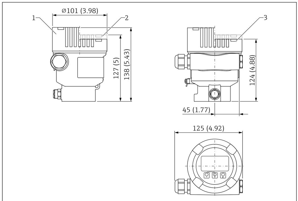
50 Dimensões; invólucro de compartimento único, alumínio, revestido; incl. acoplamento e conector M20, plástico. Unidade de medida mm (in)
