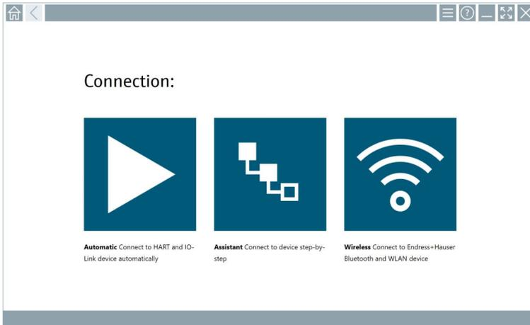
**i** Field Xpert 소프트웨어는 현장 계기에 연결하는 세 가지 방법을 제공합니다. 사용 가능한 버전은 프로토콜, 인터페이스(모뎀/게이트웨이) 및 현장 계기에 따라 다릅니다.
