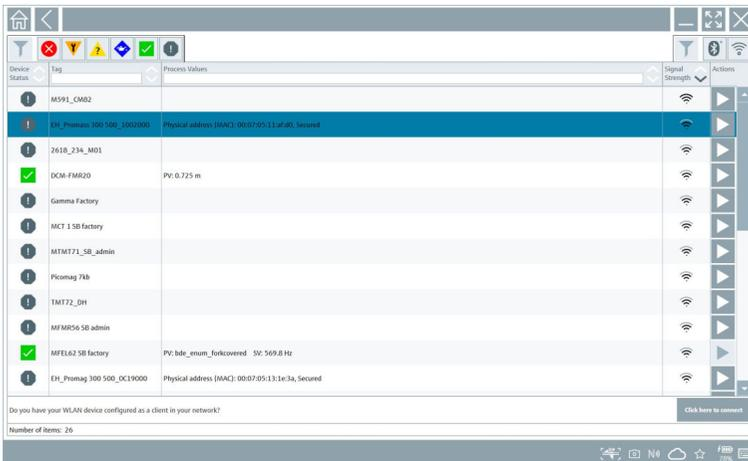
실시간 목록에서 Bluetooth 및 WLAN 현장 계기를 기준으로 필터링할 수 있습니다. ⓘ 아이콘을 누르면 Bluetooth 현장 계기의 필터가 켜지거나 꺼집니다. 📶 아이콘을 누르면 WLAN 현장 계기의 필터가 켜지거나 꺼집니다.
