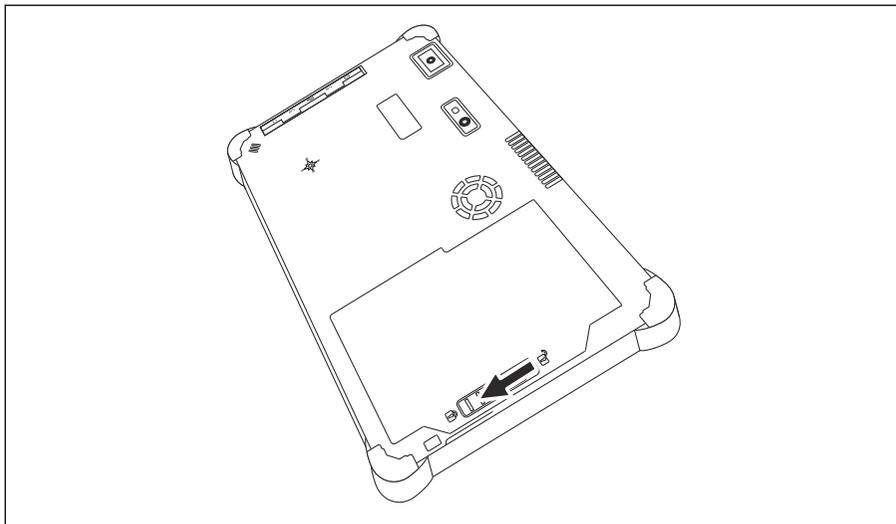
Fare scorrere il blocco batteria portandolo in posizione di blocco.
