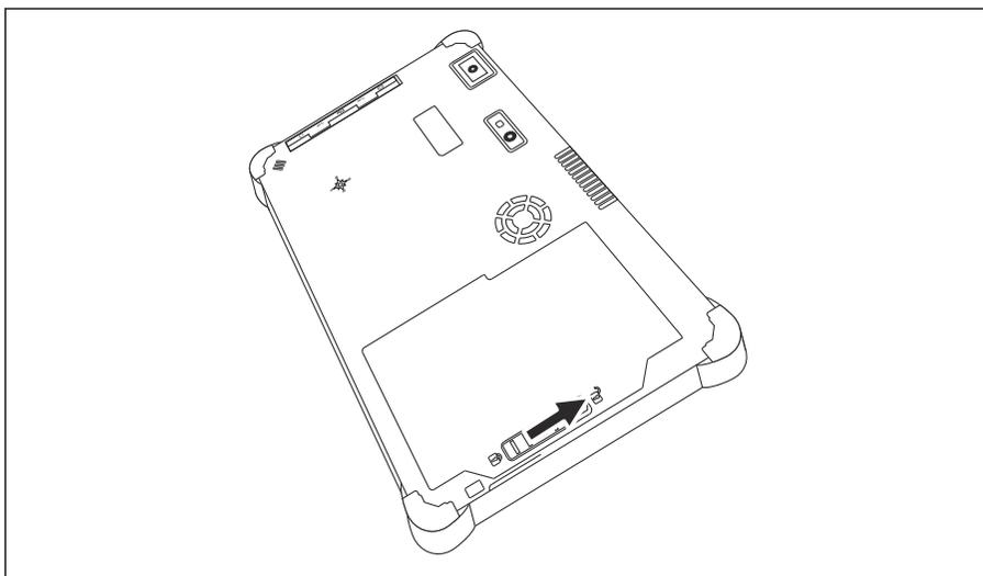
Fare scorrere il blocco batteria portandolo in posizione di sblocco.
