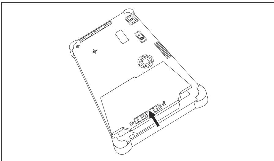
Aprire il vano batteria e rimuovere la batteria.
