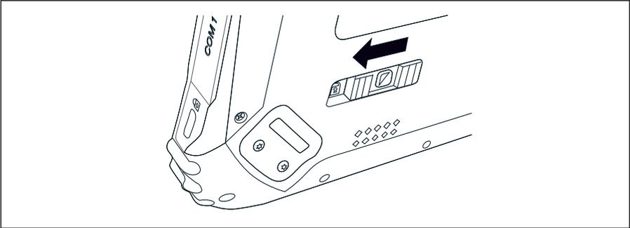
将平板电脑后部的滑动控制键按向左侧，以松开电池盖上的锁。
