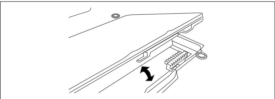
插入电池，装回电池盖并将滑动控制键按向右侧以将其锁止。
