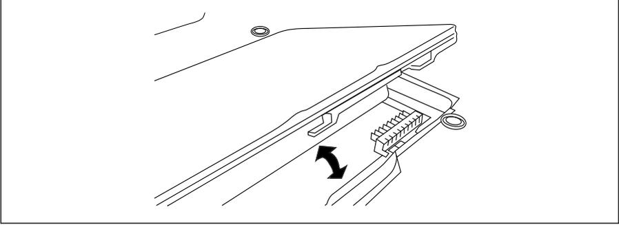
Inserte la batería, coloque de nuevo en su sitio la cubierta de la batería y desplace el control deslizante hacia la derecha para bloquear el cierre.
