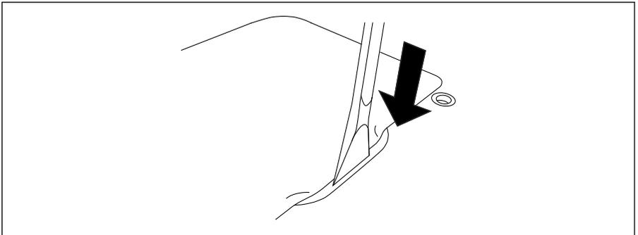
Use la palanca de plástico incluida en el suministro para abrir la cubierta de la batería.
