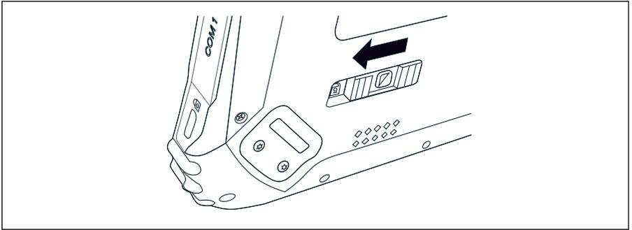
Abra el cierre de la cubierta de la batería; para ello, empuje hacia la izquierda el control deslizante situado en la parte trasera de la tableta.
