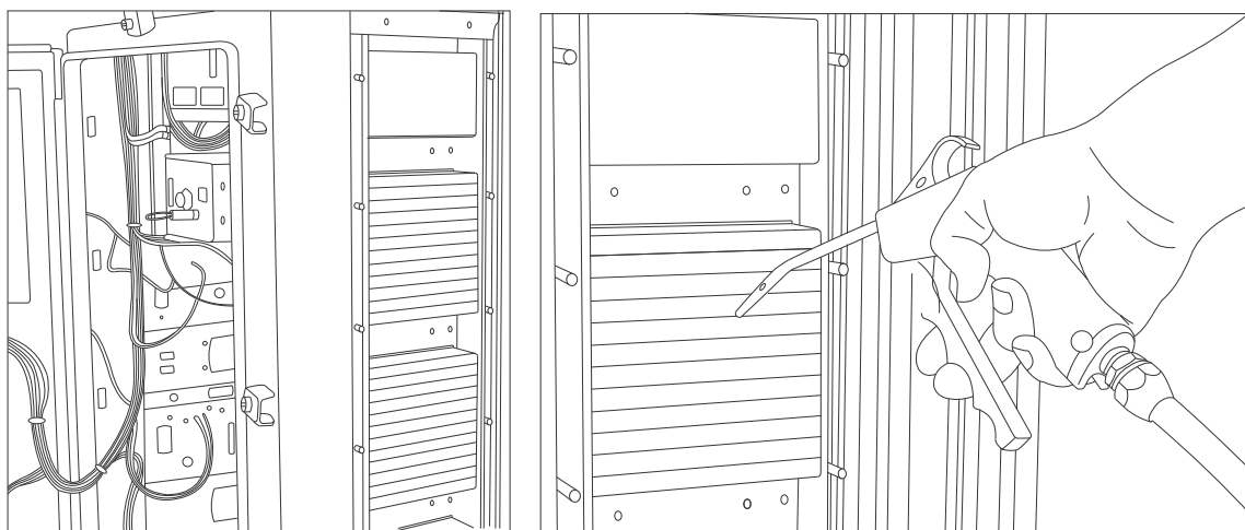
Рисунок 46. Очистка радиаторов с помощью сжатого воздуха или воды
