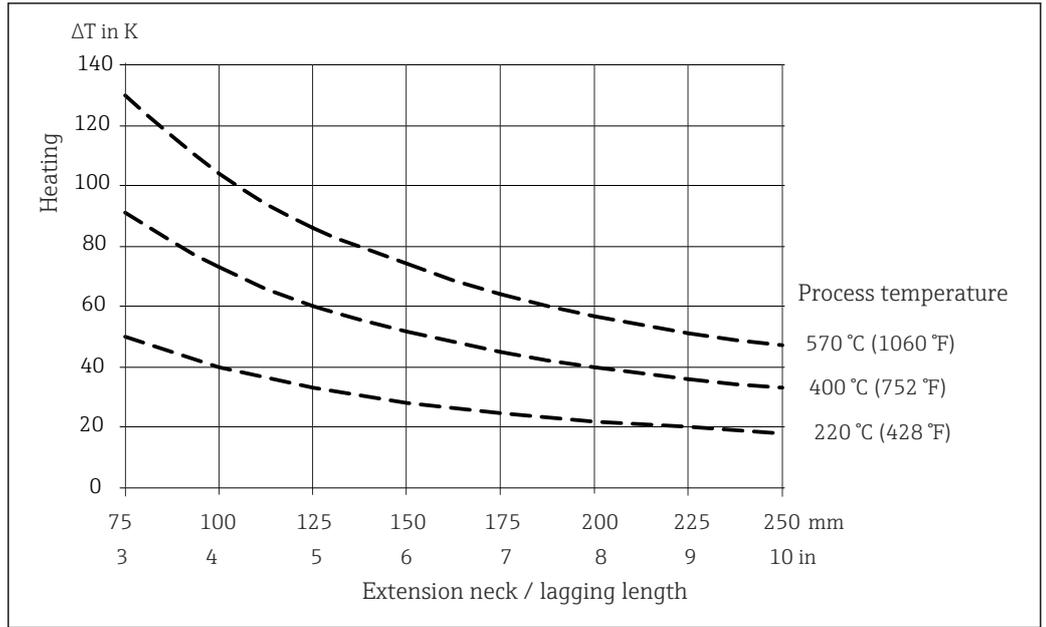
14 Calentamiento del cabezal terminal en función de la temperatura del proceso. Temperatura en el cabezal terminal = temperatura ambiente 20 °C (68 °F)+ ΔT
