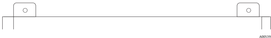
Figura 14. Pestañas de montaje de la parte superior de la envolvente
