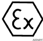
Figura 3. Etiqueta ATEX para uso em áreas classificadas
