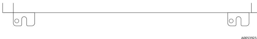
Figura 8. Linguette di montaggio inferiori scanalate della custodia
