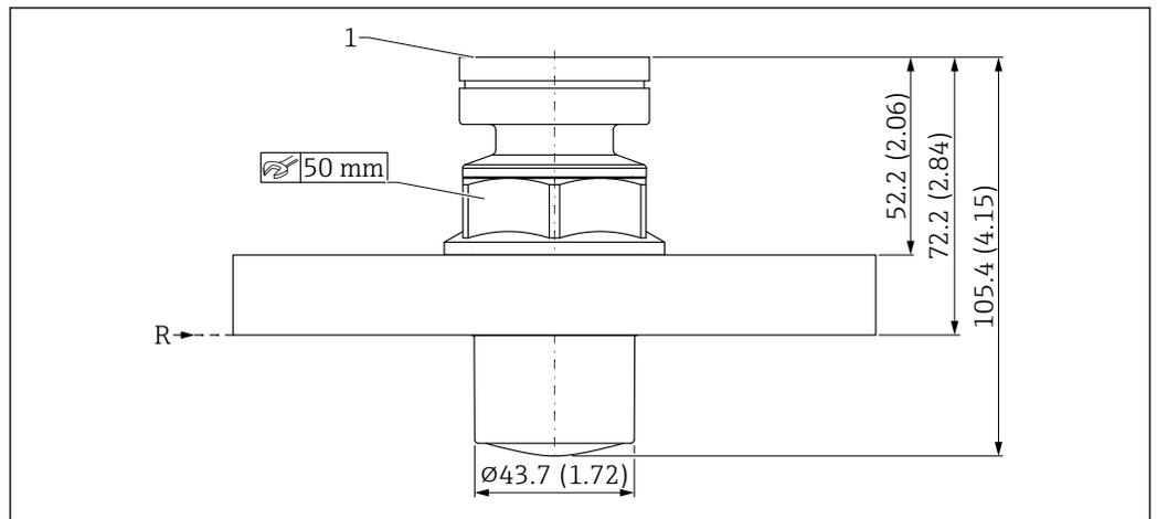
48 Medidas de la antena encapsulada, PVDF, 40 mm (1,5 in), conexión a proceso: brida UNI. Unidad de medida mm (in)
