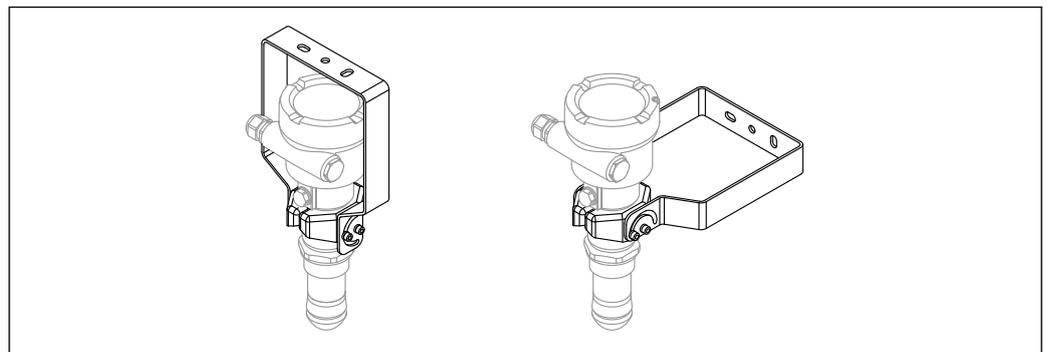
68 Soporte de montaje ajustable FMR6xB; montaje en pared o en techo
