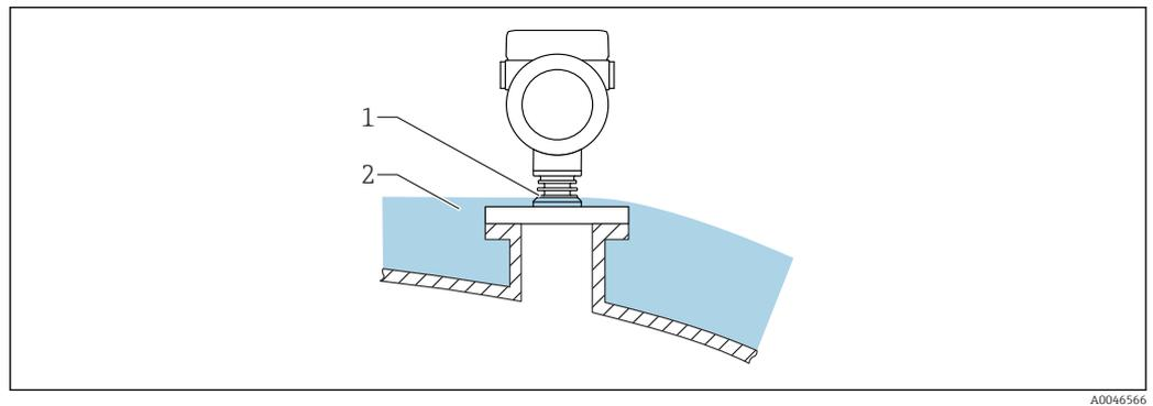
Si las temperaturas de proceso son altas, el equipo debería estar incluido en el sistema de aislamiento de containers (2) habitual para evitar que la electrónica se caliente debido a la radiación por dispersión térmica o la convección. La estructura de la nervadura (1) no debe estar aislada.
