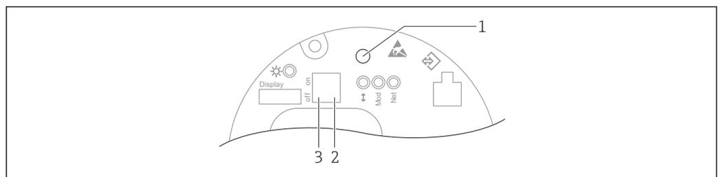
63 Teclas de configuración y microinterruptores en el módulo del sistema electrónico Ethernet-APL
