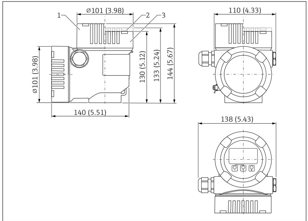
45 Medidas; caja de compartimento doble, forma de L, aluminio, recubierto; incl. acoplamiento M20 y tapón, plástico. Unidad de medida mm (in)
