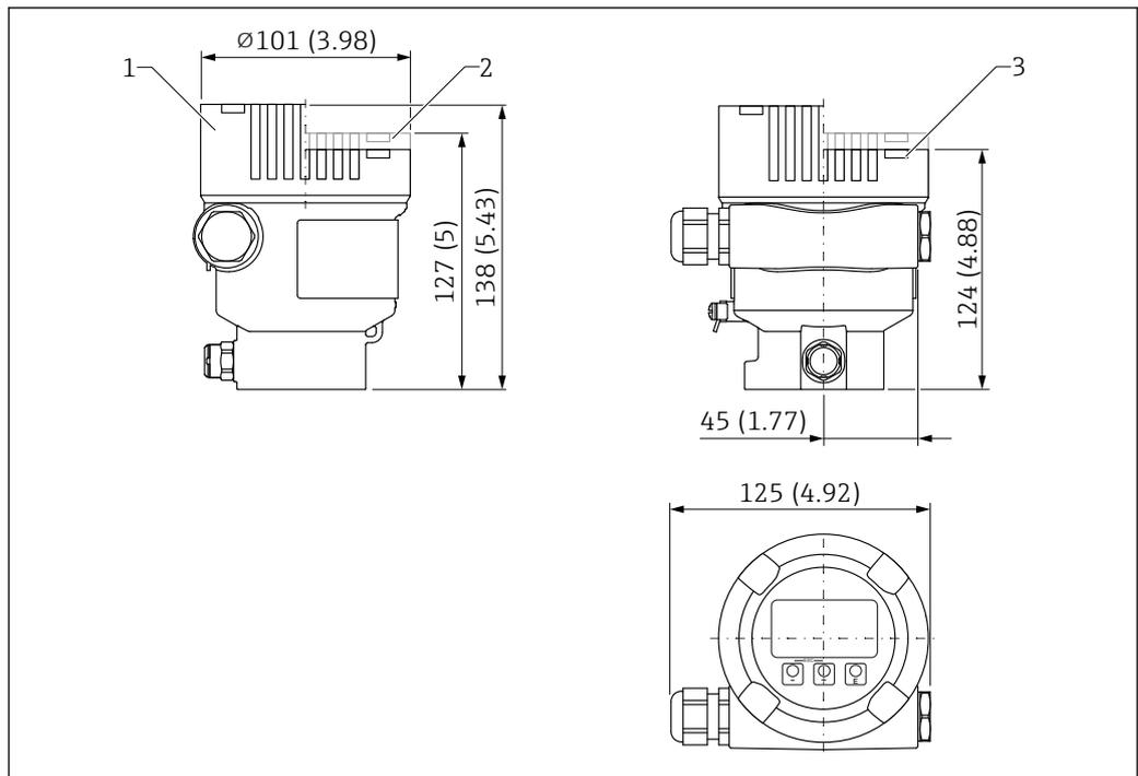
42 Medidas; caja de compartimento único, aluminio, recubierto; incl. acoplamiento M20 y tapón, plástico.
