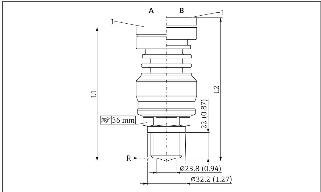
57 Medidas; antena integrada, PEEK, 20 mm (0,75 in); conexión a proceso, rosca de 3/4". Unidad de medida mm (in)
