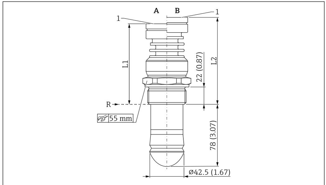
52 Medidas de la antena de goteo de 50 mm (2 in), conexión a proceso roscada
