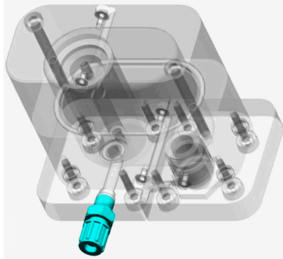
25 Verschraubung D 4/6 × G 1/8" PP am Heizfilter
