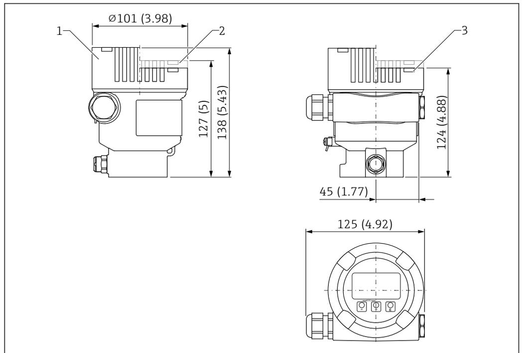
41 Dimensioni; custodia a vano unico, in alluminio, rivestita; completa di raccordo M20 e tappo in plastica.
