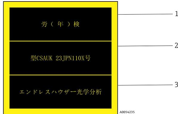
Abbildung 4. JPEX-Etikett für den Einsatz in explosionsgefährdeten Bereichen
