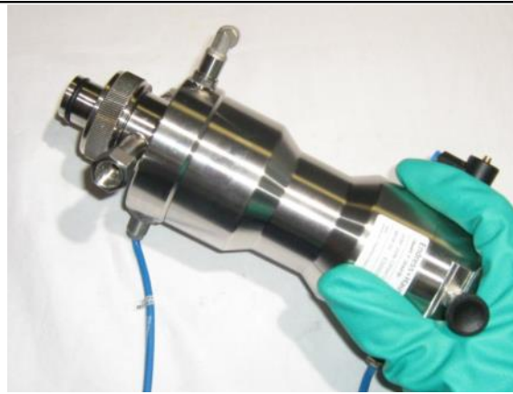
Abbildung 2 Armatur bei der Gewinde- version ansetzen
