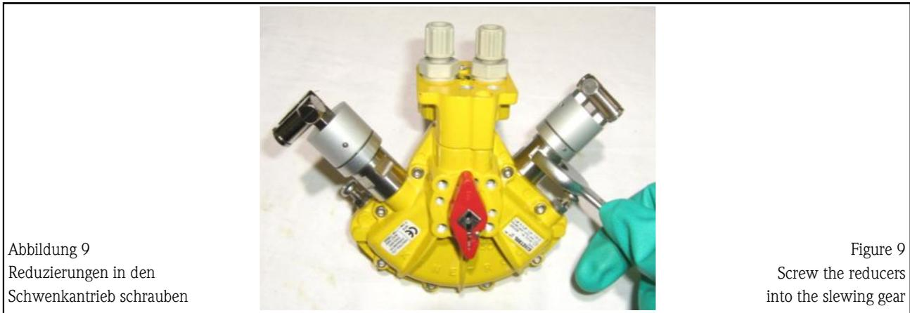
13. Falls erforderlich, drehen Sie die Antriebsachse des Schwenkantriebs, am roten Markierungsgriff, bis zum Anschlag im Uhrzeigersinn, mit einem Flachschlüssel 9 mm, in die geöffnete Position des Kugelhahns.
