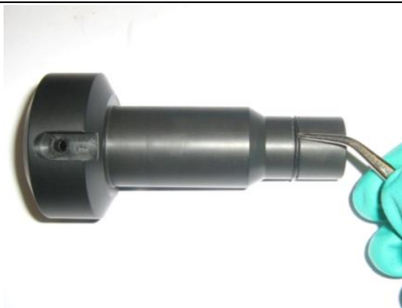
Abbildung 2 O-Ring auf das Schutzrohr schieben
