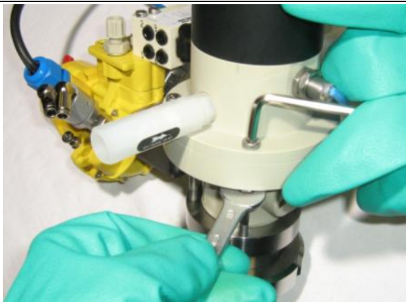
Abbildung 8 Inbusschrauben am Spülgehäuse gleichmäßig anziehen
