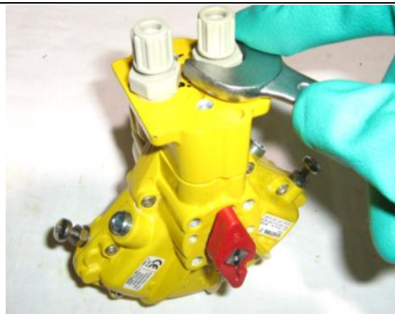
Abbildung 4 Verschraubungen in Schwenkantrieb drehen
