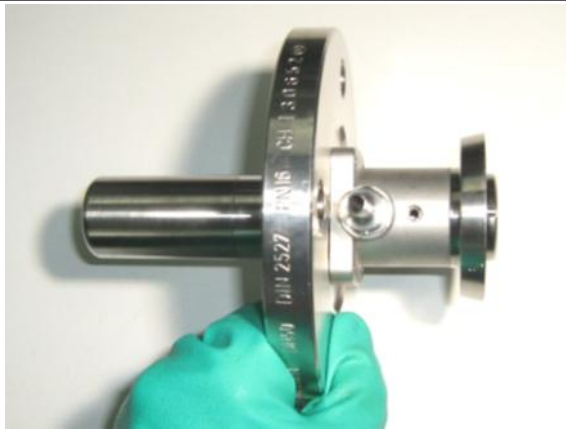
Abbildung 54 Flansch auf das Tauchrohr- Vorderteil schieben
