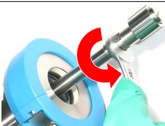
Abbildung 10 Tauchrohr vom gebrauchten Antrieb lösen
