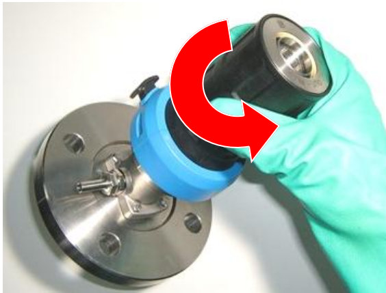
Abbildung 39 Hubrohr/Führungsrohr in die Service-Position drehen
