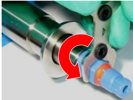
Abbildung 3 Elektrode/Sensor aus der Elektrodenführung drehen
