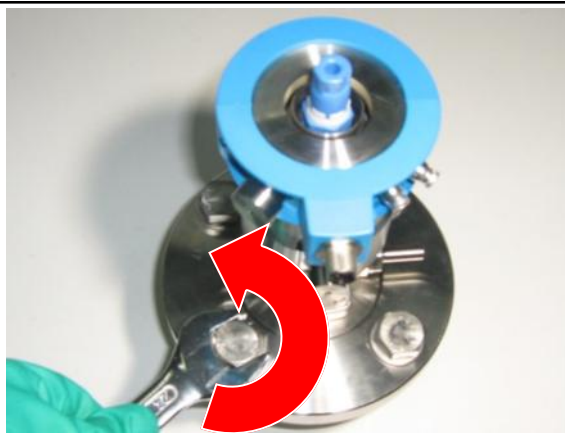
Abbildung 10 Armatur am Flansch demontieren
