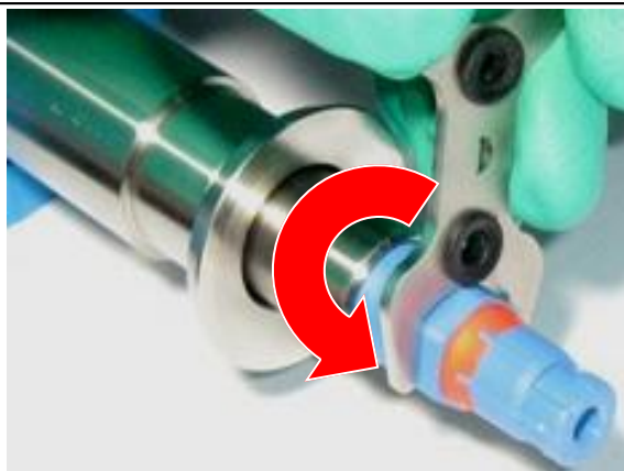
Abbildung 3 Elektrode/Sensor aus der Elektrodenführung drehen
