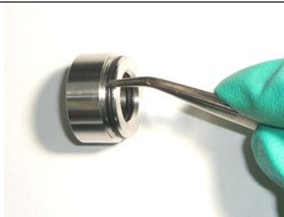
Abbildung 40 O-Ring auf den Tauchrohr-Adapter schieben
