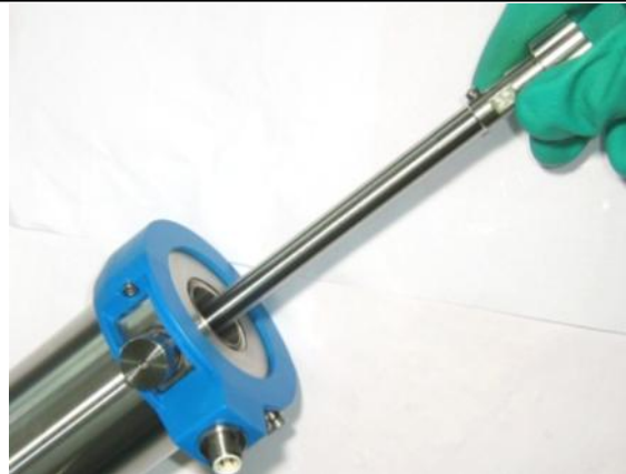
Abbildung 8 Werkzeug in den gebrauchten Antrieb schieben
