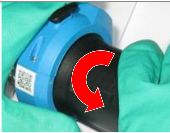
Abbildung 1 Hubrohr/Führungsrohr in die Service-Position drehen
