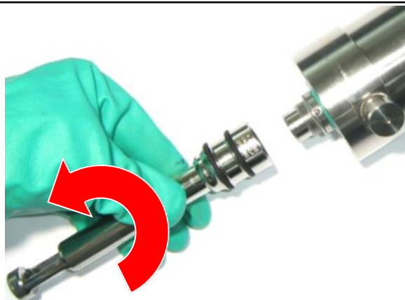
Abbildung 11 Tauchrohr vom gebrauchten Antrieb drehen
