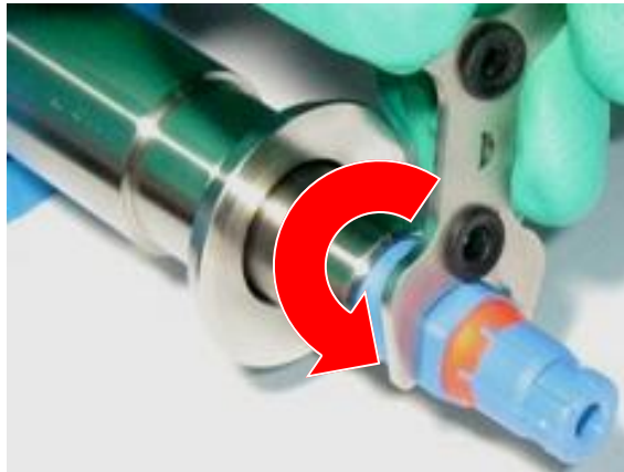
Abbildung 3 Elektrode/Sensor aus der Elektrodenführung drehen
