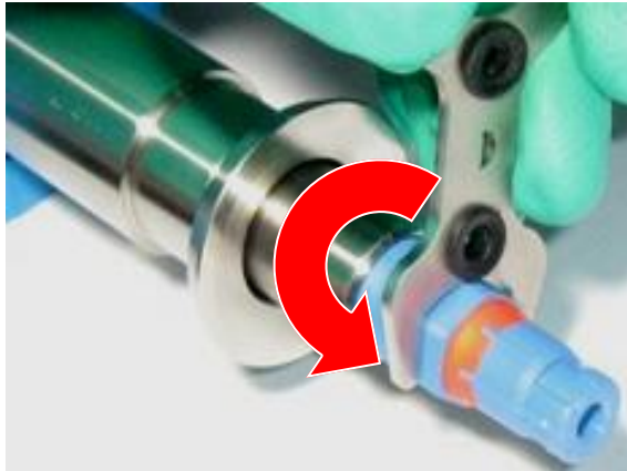
Abbildung 3 Elektrode/Sensor aus der Elektrodenführung drehen
