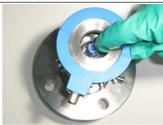
Abbildung 2 Tauchrohr im Antrieb bewegen
