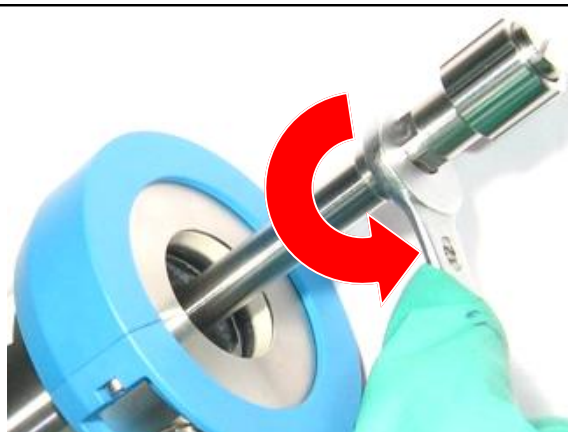
Abbildung 10 Tauchrohr vom gebrauchten Antrieb lösen
