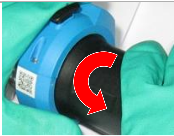
Abbildung 1 Hubrohr/Führungsrohr in die Service-Position drehen
