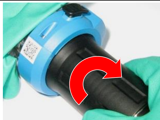
Abbildung 11 Hubrohr/Führungsrohr in die Mess-Position bewegen
