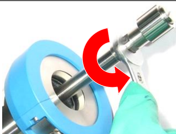
Abbildung 10 Tauchrohr vom gebrauchten Antrieb lösen
