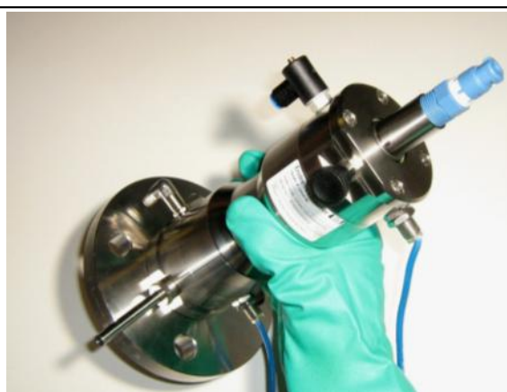
Abbildung 9 Armatur abnehmen Figure 9 Detach the process assembly
