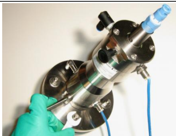
Abbildung 8 Armatur von der Prozessbefestigung lösen Figure 8 Loosen the process assembly from the process fitting
