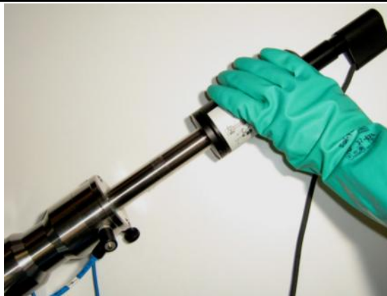
Abbildung 1 KCl-Hubrohr/Führungsrohr in die Service-Position ziehen
