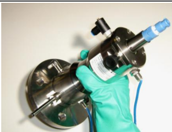
Abbildung 9 Armatur abnehmen Figure 9 Detach the process assembly
