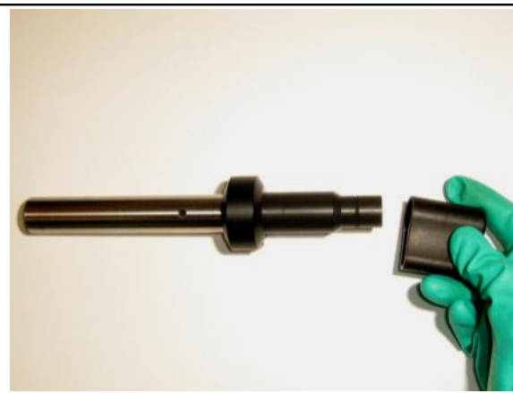
Abbildung 5 Spritzschutzkappe vom Schutzrohr abziehen
