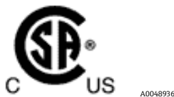
Рисунок 4. Этикетка, указывающая на допуск оборудования для использования во взрывоопасных зонах в США и в Канаде
