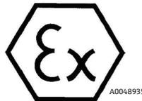
Abbildung 5. ATEX-Kennzeichnung für den Einsatz in explosionsgefährdeten Bereichen
