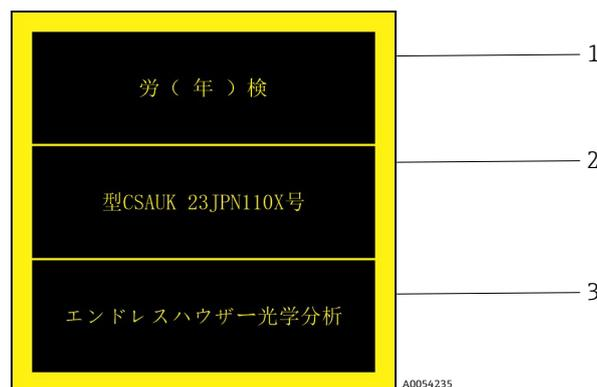
Abbildung 7. JPEX-Kennzeichnung für den Einsatz in explosionsgefährdeten Bereichen
