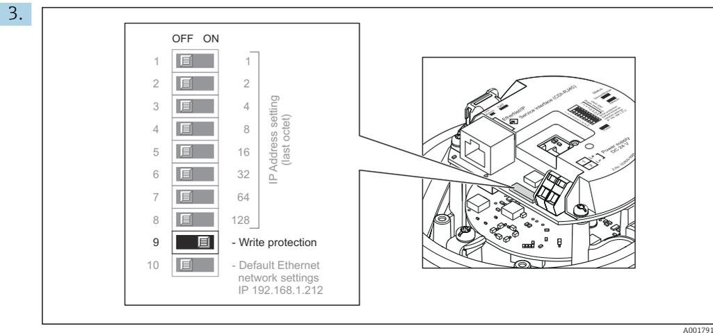
Для активации аппаратной блокировки установите переключатель защиты от записи в электронном модуле ввода/вывода в положение «**ВКЛ.**». Для деактивации аппаратной блокировки установите переключатель защиты от записи в электронном модуле ввода/вывода в положение «**ВЫКЛ.**» (заводская настройка).
