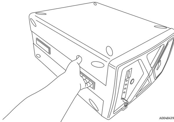
Figura 1. Alça de içamento integrada do Raman Rxn2
