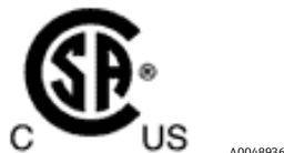
Figura 4. Etichetta che indica che l'apparecchiatura è approvata per l'uso in aree pericolose in Stati Uniti e Canada
