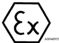
Figura 5. Etichetta ATEX per impiego in aree a rischio d'esplosione
