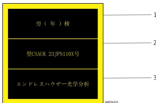
Figura 7. Etichetta JPEx per impiego in aree a rischio d'esplosione
