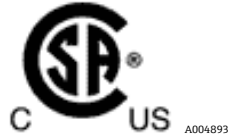
Figura 5. Etiqueta que mostra que o equipamento está aprovado para uso em áreas classificadas nos Estados Unidos e Canadá
