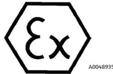
Figura 6. Etiqueta ATEX para uso en áreas de peligro
