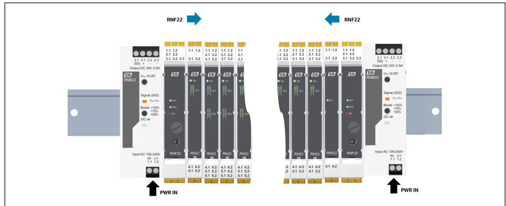
図 14 2 台の RNF22 電源モジュールを使用した電源供給の例
