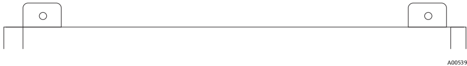
Abbildung 14. Obere Befestigungslaschen des Gehäuses
