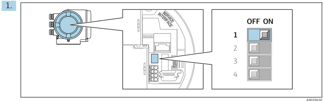
Impostando il microinterruttore di protezione scrittura (WP) sul modulo dell'elettronica principale in posizione **ON**, si attiva la protezione scrittura hardware.
