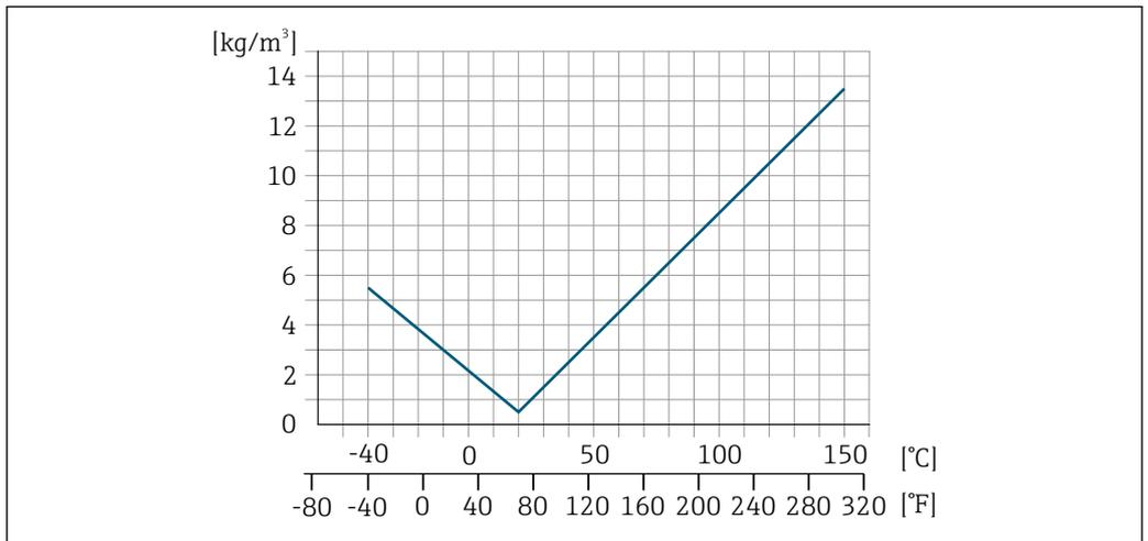
35 Regolazione della densità in campo, ad es. a  $+20 \text{ }^\circ\text{C}$  ( $+68 \text{ }^\circ\text{F}$ )
