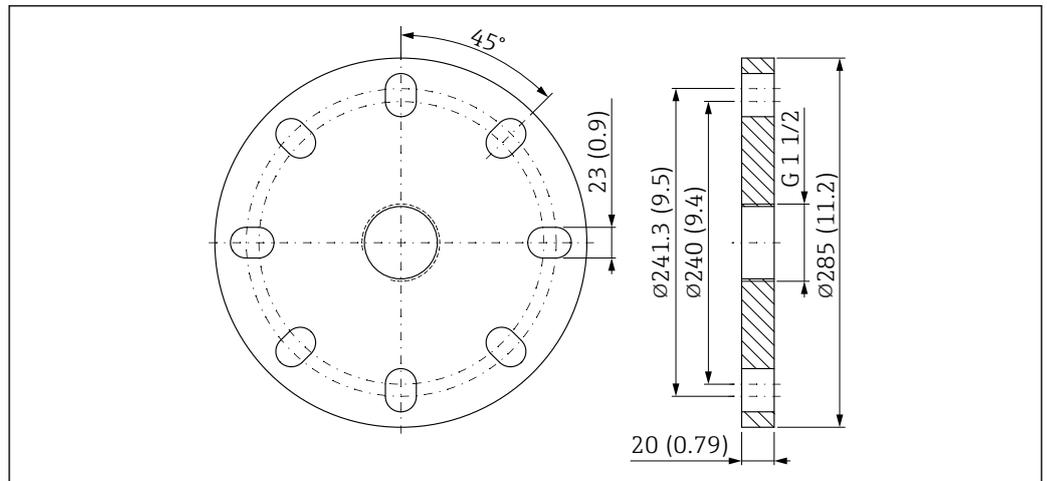
図 55 UNI フランジ 6"/DN150/150A の寸法。測定単位 mm (in)
