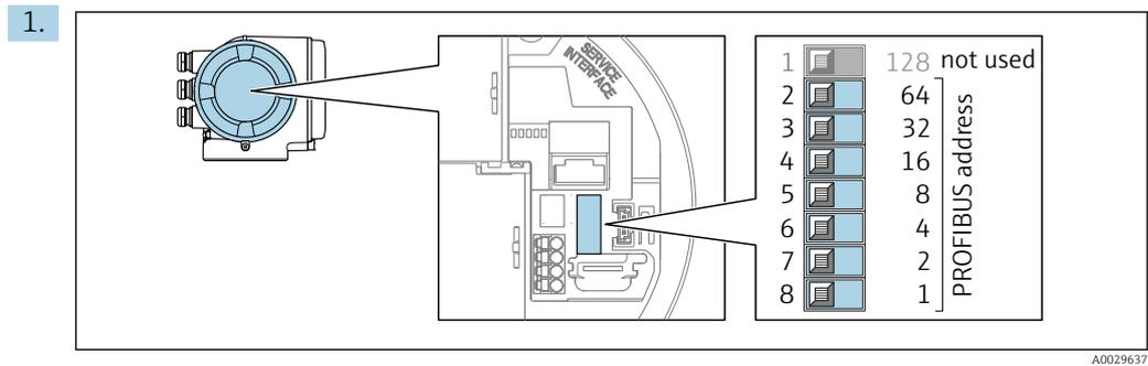
Impostare l'indirizzo desiderato utilizzando i DIP switch nel vano connessioni.
