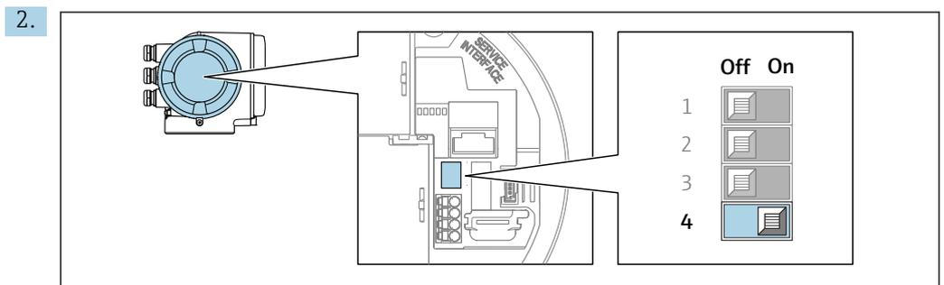
Para alternar entre o endereçamento do software e do hardware: coloque a minisseletora em **On**.
