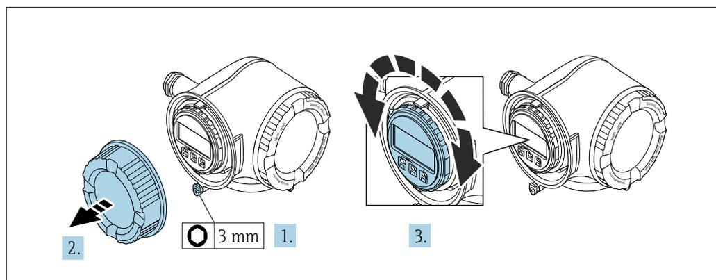
1. Dependendo da versão do equipamento: Solte a braçadeira de fixação da tampa do compartimento de conexão.
