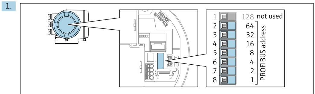
Configure la dirección deseada del equipo mediante los microinterruptores situados en el compartimento de conexiones.
