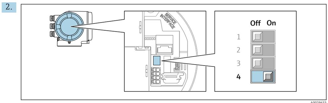
Para pasar de direccionamiento por software a direccionamiento por hardware: Ponga el microinterruptor en la posición **On**.
