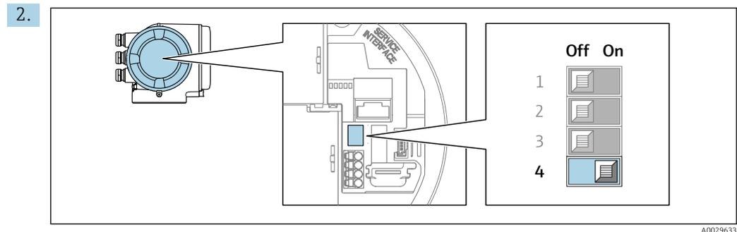
Per passare da metodo di indirizzamento software a metodo di indirizzamento hardware: impostare il DIP switch su **On**.
