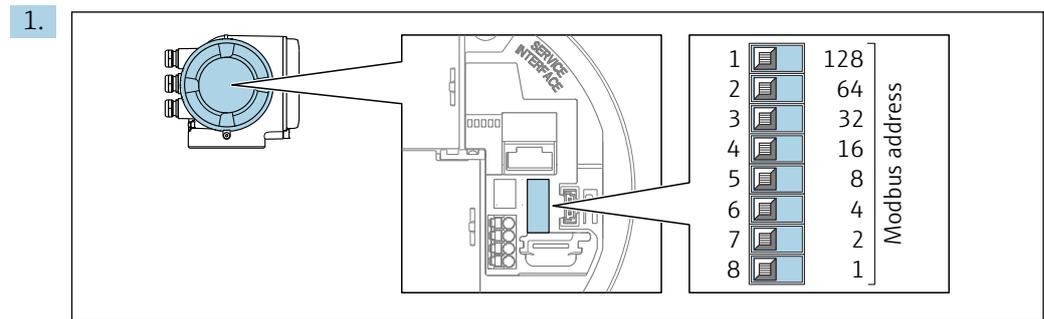
Impostare l'indirizzo desiderato utilizzando i DIP switch nel vano connessioni.
