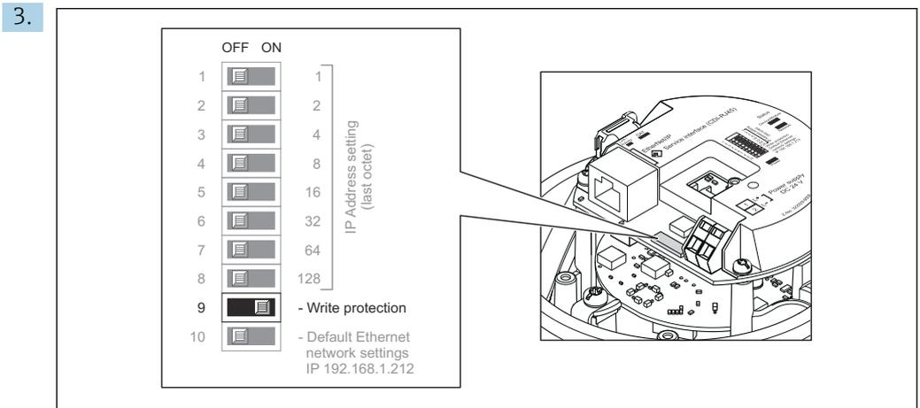
Impostando il contatto di protezione scrittura sul modulo dell'elettronica I/O sulla posizione **ON**, si attiva la protezione scrittura hardware. Impostando il contatto di protezione scrittura sul modulo dell'elettronica I/O sulla posizione **OFF** (impostazione di fabbrica), si disattiva la protezione scrittura hardware.
