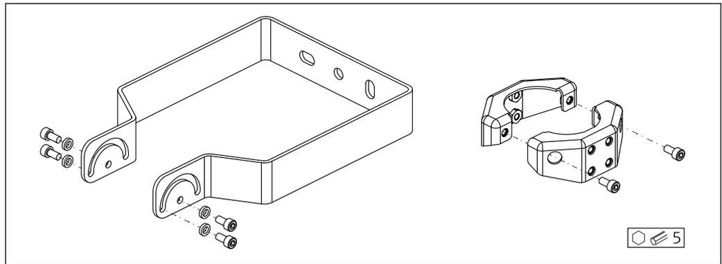
图 43 供货清单; FMR6xB 的安装架 (可调节)
