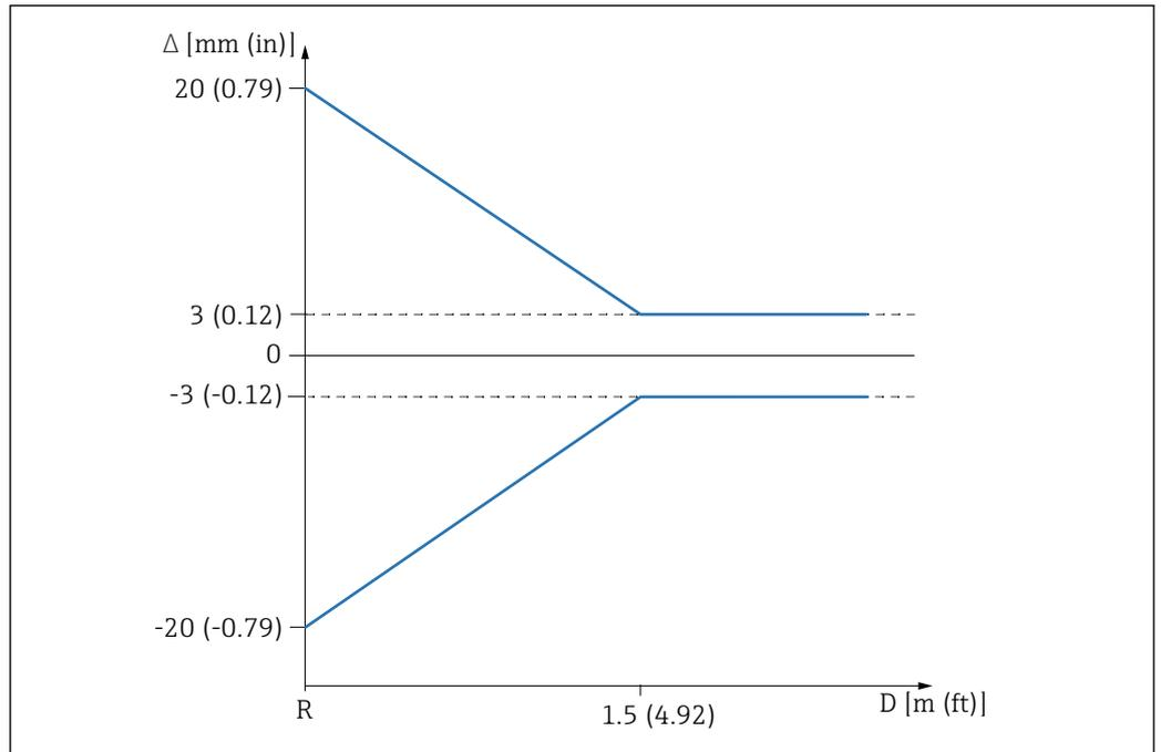
图 7 近距离测量时的最大测量误差
