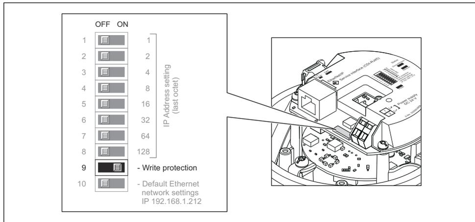
Impostando il contatto di protezione scrittura sul modulo dell'elettronica I/O sulla posizione **ON**, si attiva la protezione scrittura hardware. Impostando il contatto di protezione scrittura sul modulo dell'elettronica I/O sulla posizione **OFF** (impostazione di fabbrica), si disattiva la protezione scrittura hardware.
