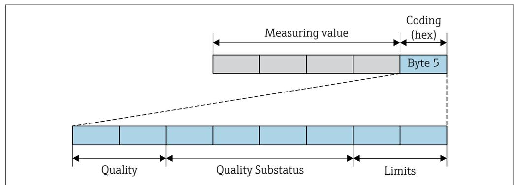
14 Struttura del byte di stato
