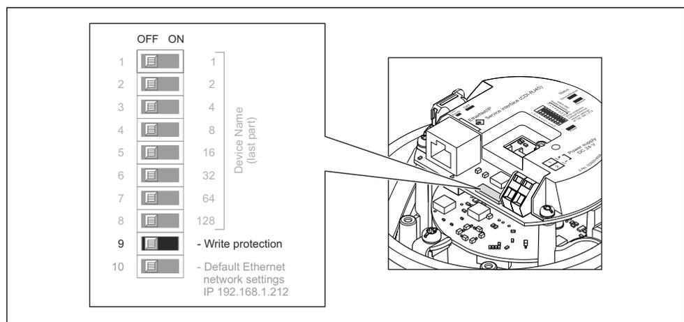
Impostando il contatto di protezione scrittura sul modulo dell'elettronica principale sulla posizione **ON**, si attiva la protezione scrittura hardware. Impostando il contatto di protezione scrittura sul modulo dell'elettronica principale sulla posizione **OFF** (impostazione di fabbrica), si disattiva la protezione scrittura hardware.
