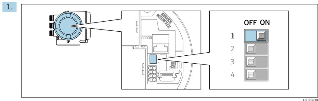
Mettre le commutateur de protection en écriture (WP) sur le module électronique principal sur **ON** permet d'activer la protection en écriture du hardware.
