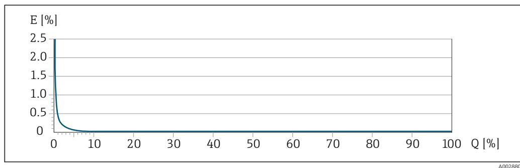
E Écart de mesure maximal en % de m. (exemple avec PremiumCal)
