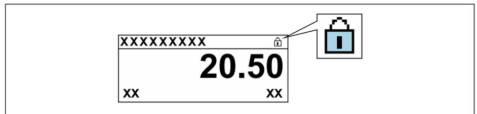
2. Al ajustar el microinterruptor WP del módulo de la electrónica principal en la posición **OFF** (ajuste de fábrica), se desactiva la protección contra escritura.
