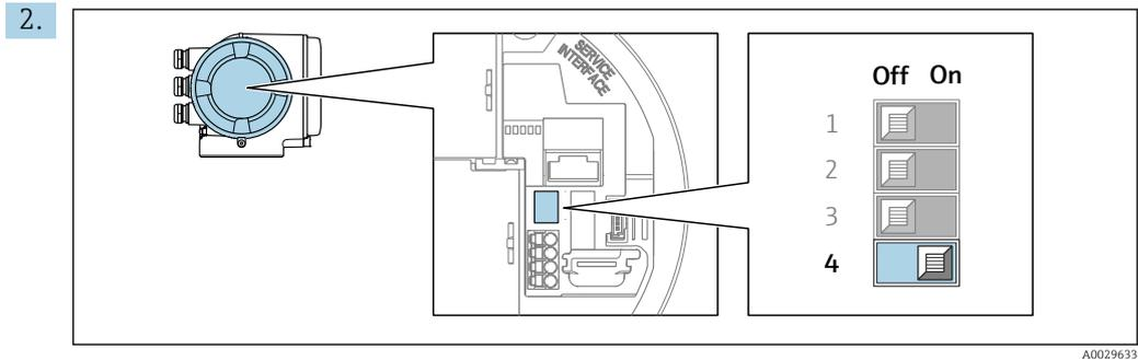
Para conmutar de direccionamiento por software a direccionamiento por hardware: Ponga el microinterruptor en la posición **On**.
