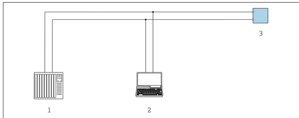
**25** Opciones para la configuración a distancia mediante el protocolo Modbus RS485 (activo)
