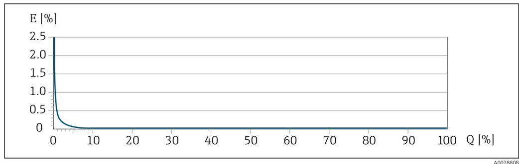
E Error máximo de medición en % v.l. (ejemplo con PremiumCal)
