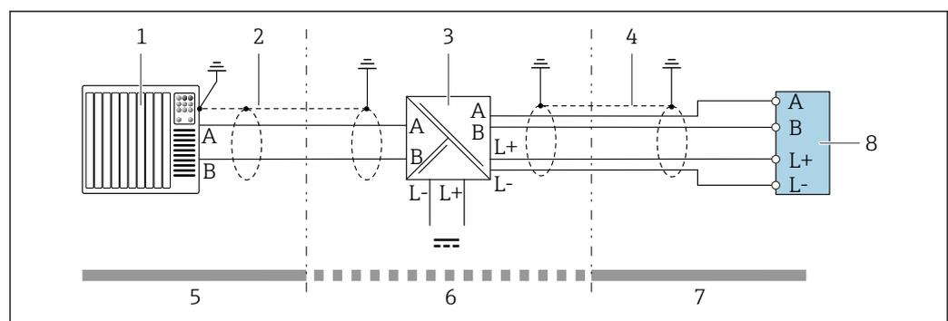
12 Raccordement électrique entre le transmetteur et la barrière de sécurité Promass 100
