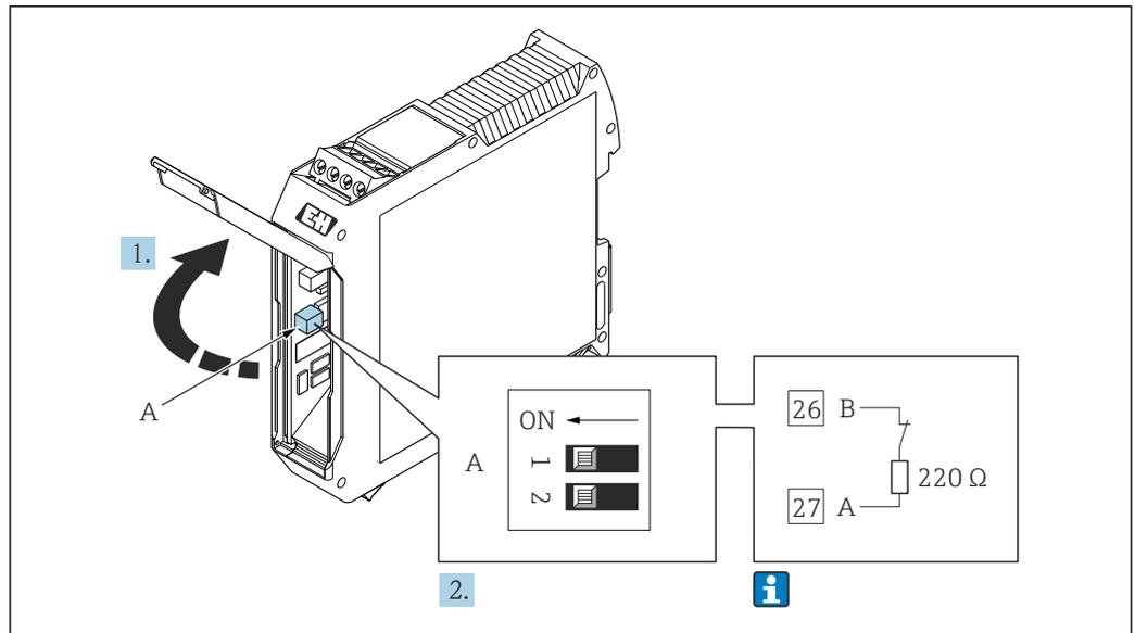
16 La résistance de fin de ligne peut être activée via le commutateur DIP dans la barrière de sécurité Promass 100
