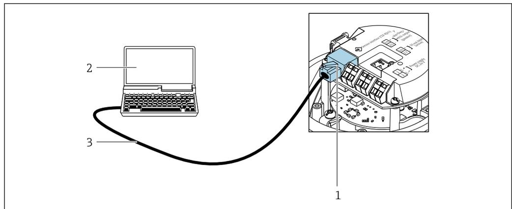
17 Raccordement pour caractéristique de commande "Sortie", Option B : 4-20 mA HART, sortie impulsion/fréquence/tor
