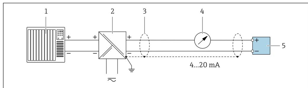
10 Exemple de raccordement pour sortie courant 4 à 20 mA HART (passive)
