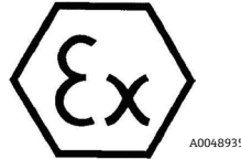
Abbildung 6. ATEX-Kennzeichnung für den Einsatz in explosionsgefährdeten Bereichen
