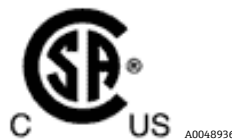
Abbildung 5. Typenschild mit der Angabe, dass das Betriebsmittel in den USA und Kanada für den Einsatz in explosionsgefährdeten Bereichen zugelassen ist
